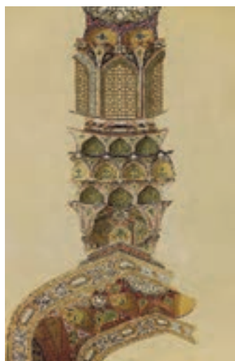
شکل ۲-۱۲- مقطعی از گنبد مرکزی کاخ هشت بهشت
