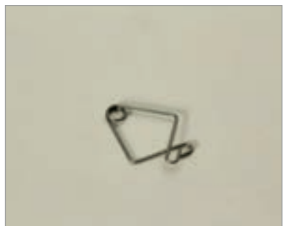
شکل ۳-۱۲۸ - سنجاق آویز بار (تا یک کیلوگرم)
