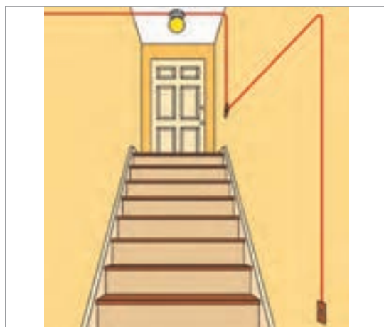
شکل ۳-۳۷- مدار الکتریکی کلید تبدیل
