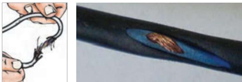
شکل ۱۸-۳- پوسیدگی و زخمی شدن سیم‌ها و کابل‌ها
