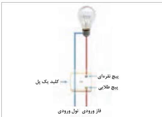
شکل ۳-۳۵- مدار الکتریکی کلید یک پل
