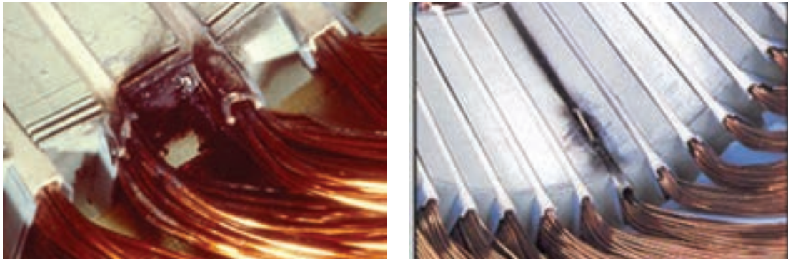
شکل ۱۰-۳- اتصال سیم‌های حامل جریان با بدنه فلزی یک موتور الکتریکی
