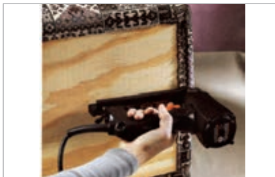
شکل ۴-۴۰- نصب پارچه در زیر صندوقچه
