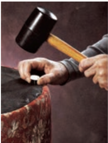
شکل ۴-۶۷- کشیدن و کوبیدن پارچه شکل ۴-۶۸- نصب پایه زیر کف
