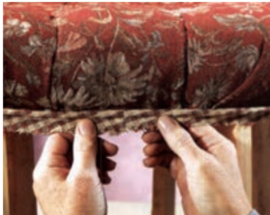
شکل ۴-۶۹- اندازه گیری و نصب سرمه
