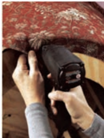
شکل ۴-۶۷- کشیدن و کوبیدن پارچه شکل ۴-۶۸- نصب پایه زیر کف
