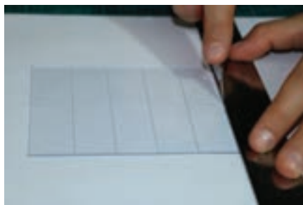
شکل ۵-۸۸- ساخت نمای شیشه‌ای با استفاده از طلق شفاف و ایجاد شیار بر روی آن
