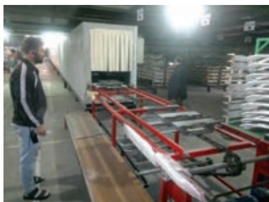
شکل ۴۰-۵- خروج قطعات از تونل
