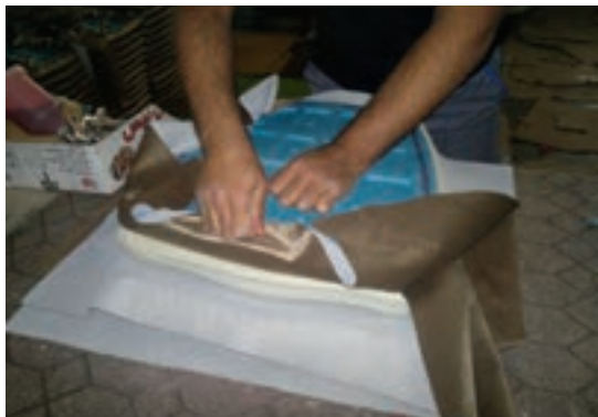
شکل ۵-۵۰ ثابت کردن پارچه از یک طرف
