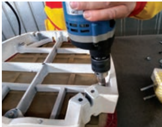
شکل ۵-۷۳- بستن شبکه زیر صندلی به کف
