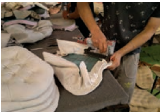
شکل ۵-۵۴ - منگنه زنی لبه‌های قطعه لمسه کاری شده
