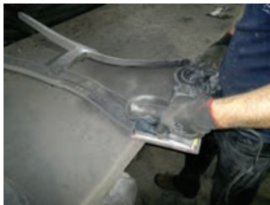
شکل ۵-۳۱- پرداخت پشت صندلی با سنباده لرزان
