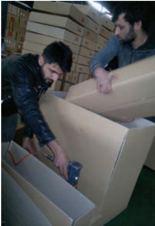
شکل ۶۷-۵- بستن کارتن با زدن منگنه
