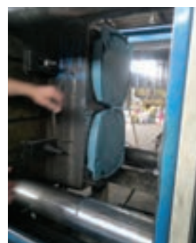
شکل ۲۶-۵- جدا کردن قالب
