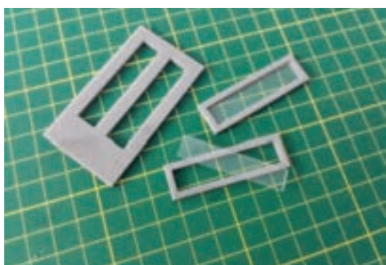
شکل ۵-۷۰- برش اجزای بدنه و درها
