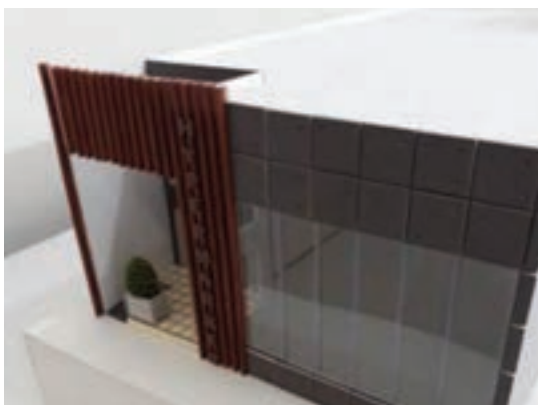
شکل ۵-۸۷- ساخت نمای چوبی: چسباندن برجسب‌های طرح چوب دور چوب بالسا
