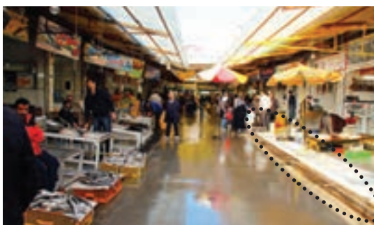
شکل ۲-۲۵- کف قابل شست و شو و مسیر جمع آوری آب بادر پوش مشبک در وسط مسیر عبور در بازار ماهی فروش ها.
