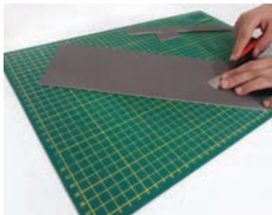
شکل ۱۱۰-۵- اجرای شیارهای رامپ با کاتر و فشار دست
