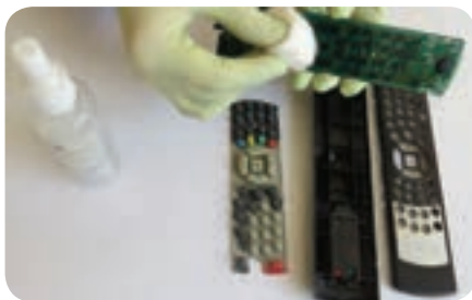
شکل ۱-۱۰- تمیز کردن کنتاکت‌ها با الکل
