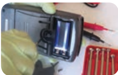
شکل ۱-۱۴- باز کردن پیچ‌ها و آزادسازی خارها
