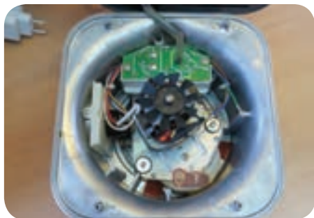
شکل ۲۴-۱- موتور، برد الکترونیکی و پروانه
