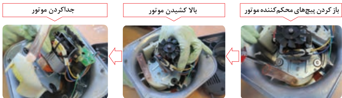
شکل ۲۶-۱- اینفوگرافی جدا کردن موتور
