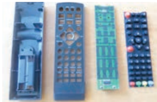
شکل ۳-۱. اجزای دستگاه ریموت کنترل
