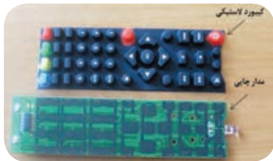
شکل ۴-۱. صفحه کلید و برد دستگاه ریموت کنترل
