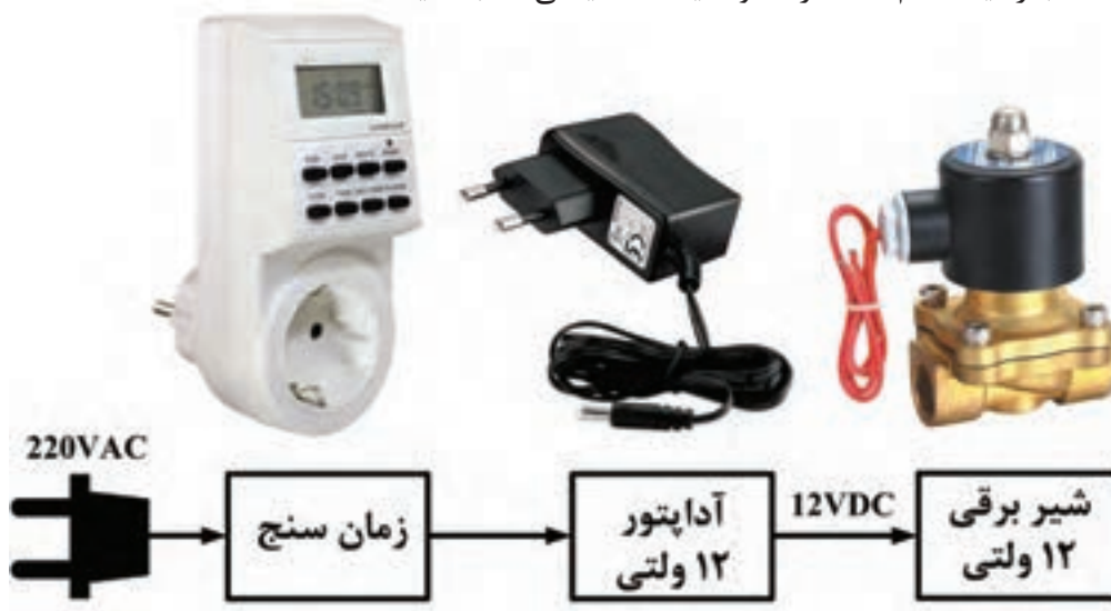
شکل ۲-۴۸- نصب شیر برقی ۱۲ ولت
