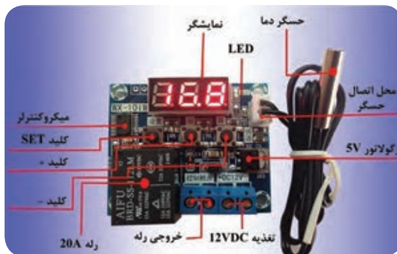
شکل ۴۲-۲. ماژول WX-101W و اجزای آن
