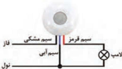
شکل ۲۸-۲- اتصال حسگر حرکتی به شبکه و لامپ
