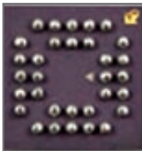
شکل ۳۳ - تصویر ظاهری انواع پکیج‌های BGA
