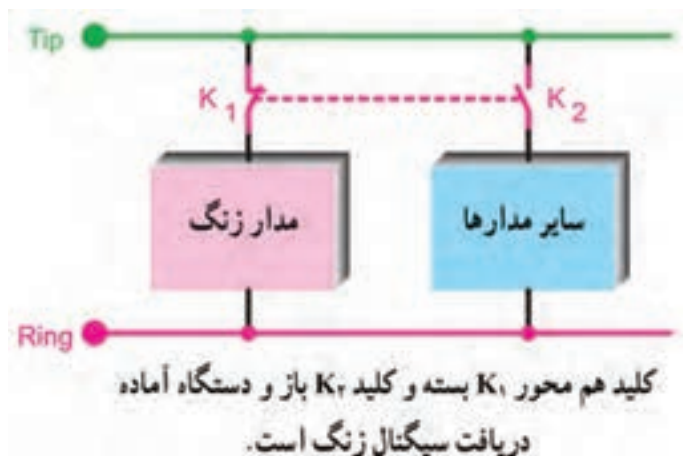
شکل ۲۰-۵. بلوک دیاگرام مدار زنگ و سایر مدارها
