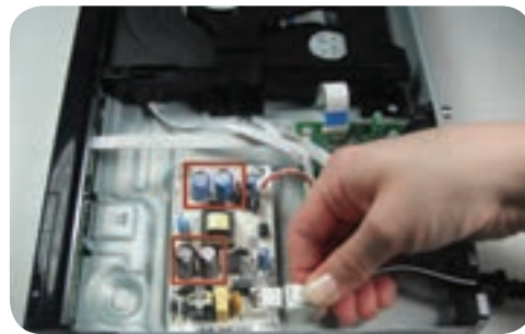
شکل ۶-۲۳ آزادکردن سوکت منبع تغذیه
