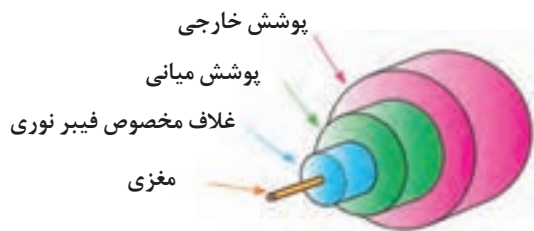
شکل ۴-۸- فیبر نوری و اجزای آن
