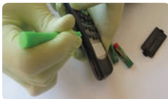
شکل ۱-۸ آزاد کردن خارهای قاب دستگاه ریموت کنترل
