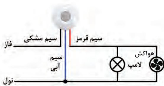
شکل ۲۸-۲ اتصال حسگر حرکتی به شبکه و لامپ و هواکش
