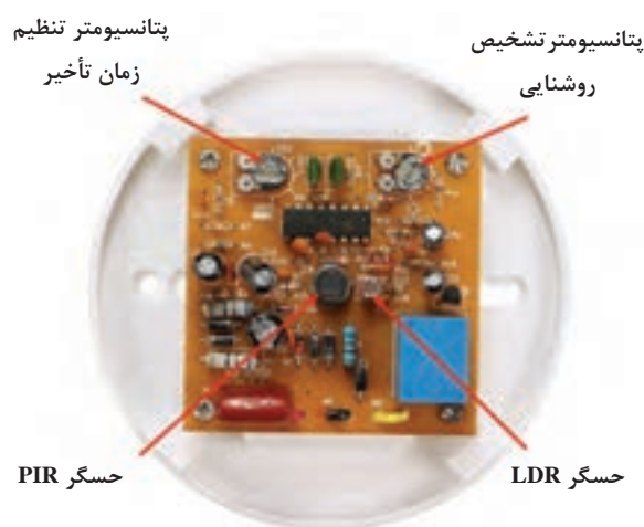
شکل ۲-۲۷- مدار داخلی یک نمونه حسگر سقفی
