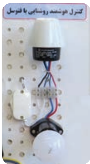
شکل ۲-۱۹- نحوه سیم‌کشی فتوسل
