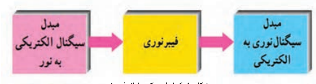
شکل ۴-۱۰- اساس یک سامانه فیبر نوری
