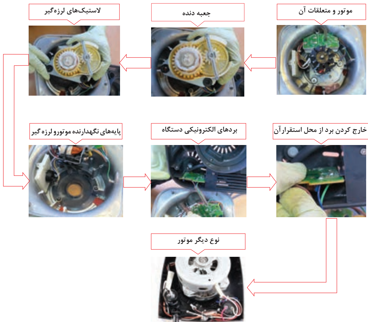
شکل ۱-۲۷- اینفوگرافی جدا کردن برد الکترونیکی دستگاه غذاساز
