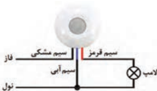
شکل ۲۸-۲ اتصال حسگر حرکتی به شبکه و لامپ
