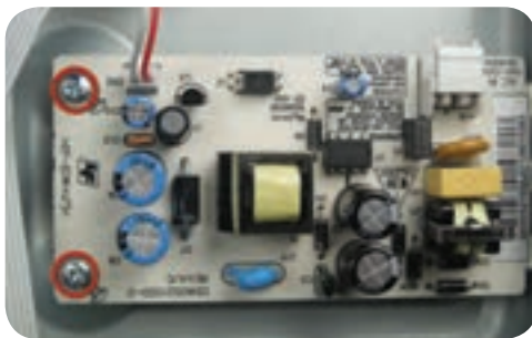
شکل ۶-۲۴ محل پیچ‌های محکم‌کننده برد منبع تغذیه
