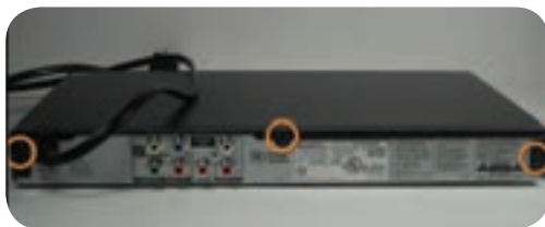
شکل ۶-۱۵ پیچ‌های پشت دستگاه
