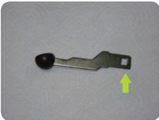
شکل ۶-۴۸ محل اتصال اهرم
