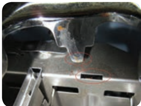
شکل ۵۸- ۶ خار نر و ماده جهت اتصال
