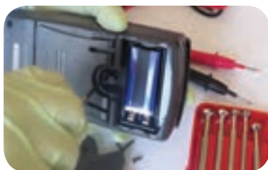
شکل ۱۴-۱- باز کردن پیچ‌ها و آزادسازی خارها
