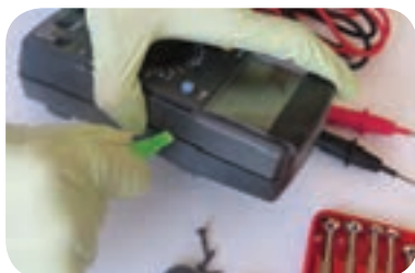
شکل ۱۵-۱- جدا کردن دو قسمت بدنه
