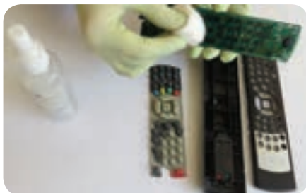
شکل ۱-۱۰ تمیز کردن کنتاکت‌ها با الکل
