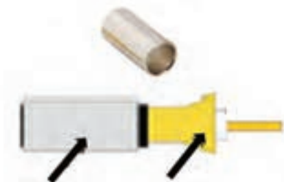
شکل ۳-۲۲- قراردادن حلقه روی کابل
