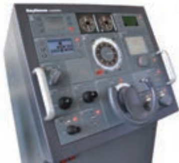
شکل ۲۶- سامانه هدایت خودکار (اتوپیلوت) در کشتی‌ها
