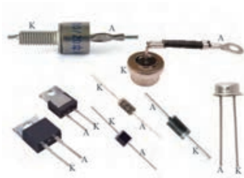
شکل ۱۴- شکل ظاهری چند دیود
