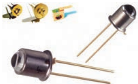
شکل ۲۵- شکل ظاهری چند نمونه فتو دیود
