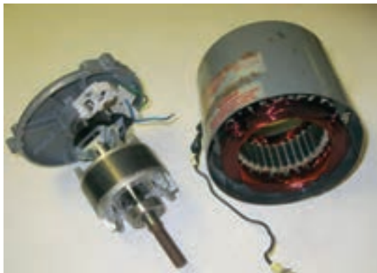
شکل ۱۸- رتور و استاتور موتور تک فاز
