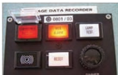
شکل ۲۰- چند نمونه پانل کنترل VDR در پل فرماندهی
