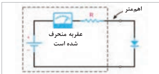
شکل ۴- دیود با باتری اهم‌متر در بایاس موافق است.
