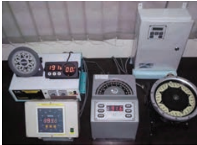
شکل ۳- یک نمونه قطب‌نمای الکتریکی (جایرو) و متعلقات آن
