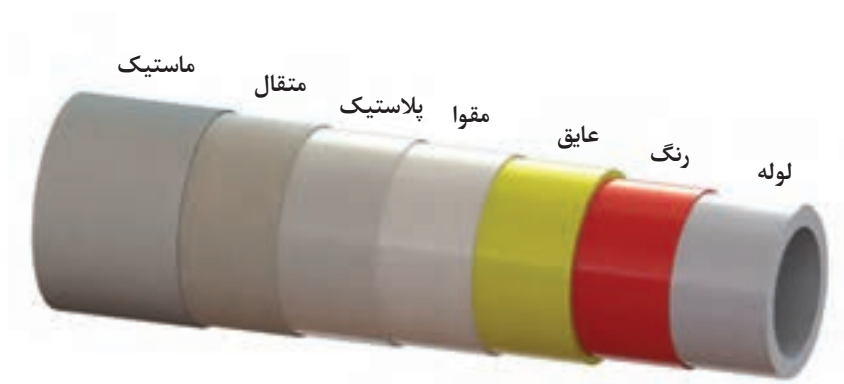
شکل ۱۲- لایه‌های عایق پشم شیشه
