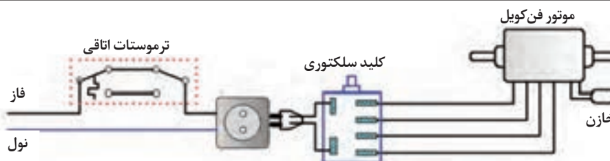
کنترل دستی دور فن دستگاه از طریق کلید سلکتوری، بدون کنترل کننده دما
