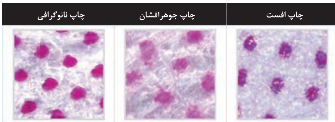
شکل ۱۲- وضعیت نقاط بر روی کاغذ بدون پوشش در سه روش چاپ افست، جوهرافشان و نانو
