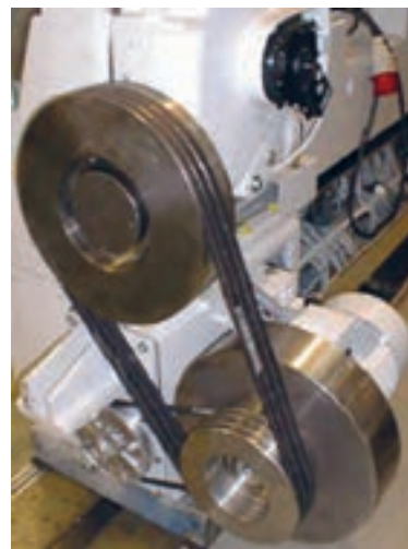
شکل ۲۲- الف) تسمه و پولی در ماشین برش گیوتینی
