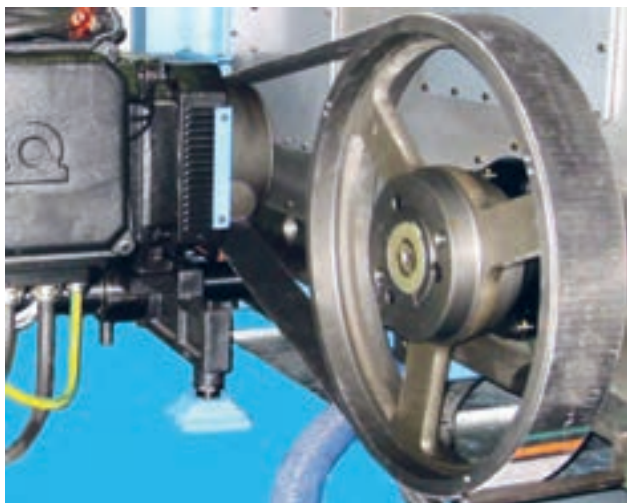
شکل ۲۲- ب) تسمه و پولی در ماشین چاپ ۱۰۰×۷۰ cm
