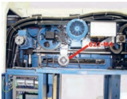
شکل ۳۰- موتور AC بالا و پایین بردن تخته کاغذ
