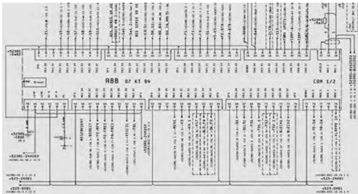
شکل ۹- ب) عکس و دیاگرام یک PLC مدل KT۹۴
