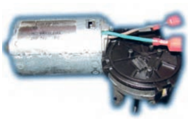
شکل ۲۸- موتور سیستم رجیستر از نمای نزدیک
