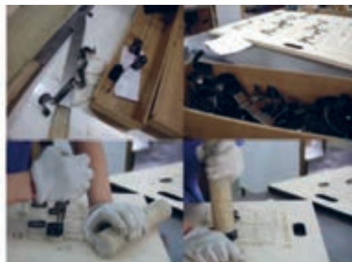
شکل ۱۰۴- قرار دادن تیغ‌ها در قالب
