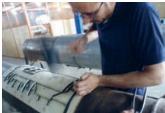
شکل ۱۳۴- جا زدن تیغ‌ها با چکش
