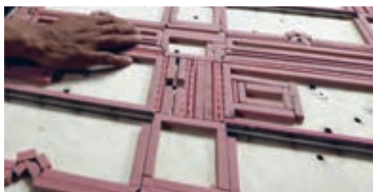
شکل ۱۲۲- قرار دادن لاستیک‌های جدا کننده روی قالب
