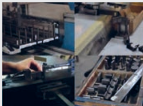
شکل ۱۰۲- خم کن با قطعات مختلف آن
