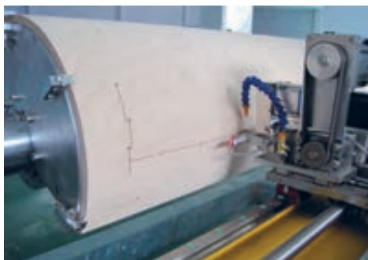
شکل ۱۲۶- برش تخته قالب با دستگاه اره CNC
