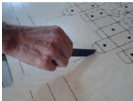
شکل ۱۴۳- بررسی ضخامت شکاف روی تخته
