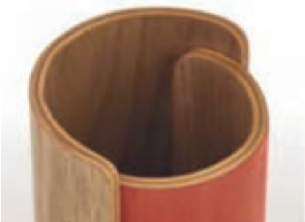
شکل ۱۳- ویژگی انعطاف‌پذیری تخته‌های چند لایه
