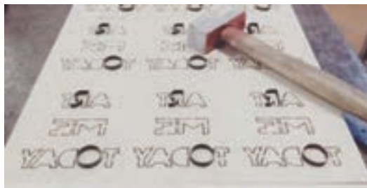
شکل ۱۱۹- جازدن تیغ‌ها
