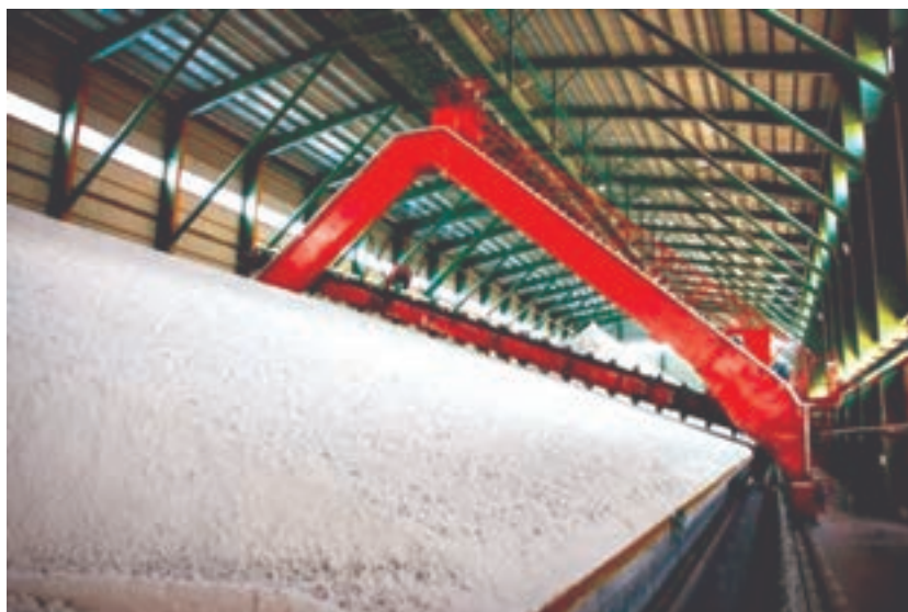
شکل ۳۰- سیلوی سقف دار و برداشت برشی مواد
