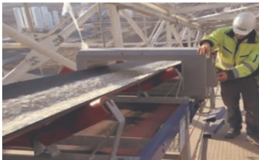
شکل ۳۱- فرایند آهن‌گیری هنگام انتقال مواد پودر شده
