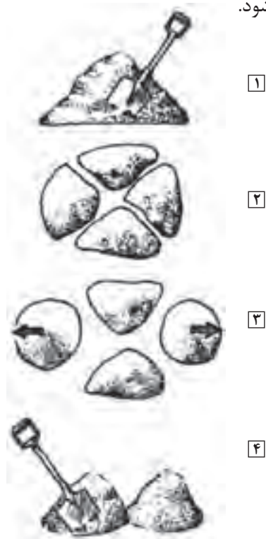
شکل ۳۷- مراحل نمونه‌برداری از آمیز
