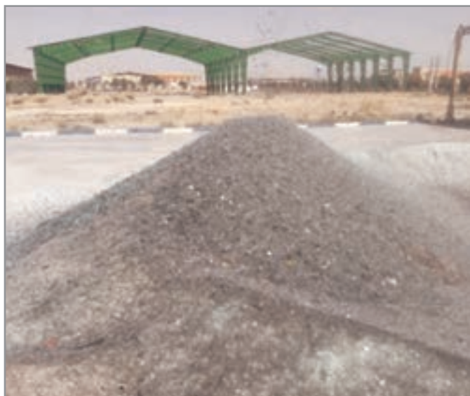
شکل ۳۹- آمیز شیشه سودا آهکی از خرده شیشه
