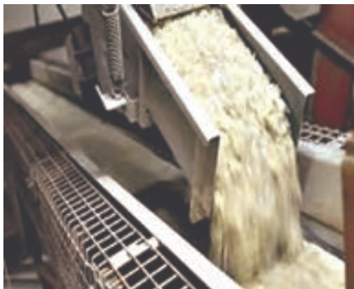
شکل ۲۶- خردایش و آهن‌گیری مواد اولیه
