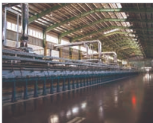
شکل ۳۰- گرمخانه تنش زدایی شیشه
