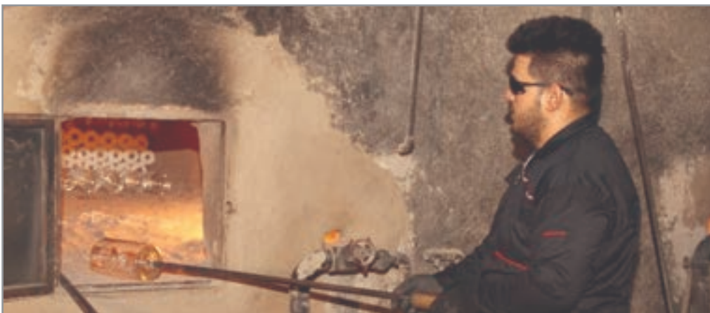
شکل ۹- قرارگیری شیشه در گرمخانه
