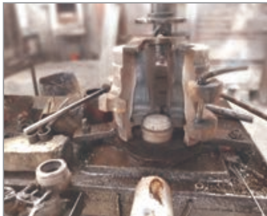
شکل ۱۳- قالب پرس بادی
