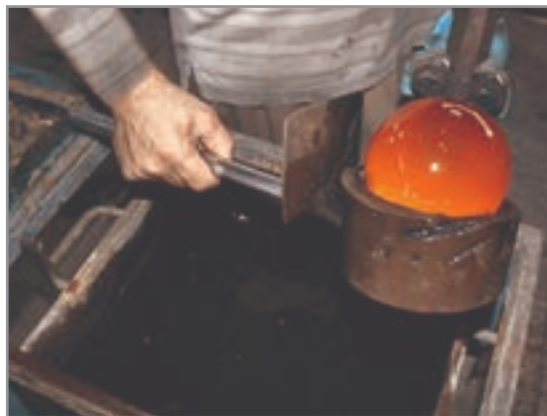
قرار گیری گوی مذاب درون قاشق
