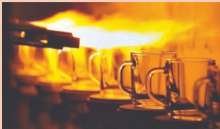
شکل ۳۵- پولیش حرارتی
