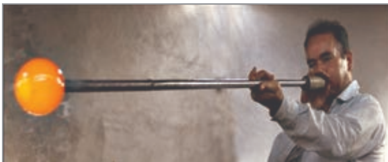
شکل ۵- ایجاد حباب در لقمه مذاب با دمیدن
