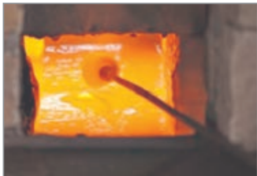
شکل ۴- افزایش قطر گوی اول با برداشتن مذاب بیشتر
