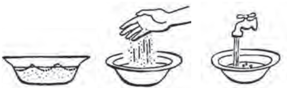
شکل ۴۱- تعیین عملی نسبت آب و گچ
