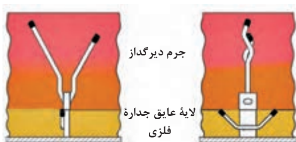
شکل ۳۷- انکر فلزی در دو نمای جلو و پهلو
