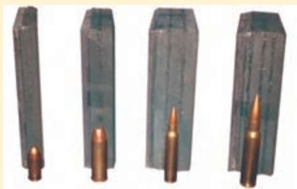
شکل ۴۱- انواع شیشه‌های ضدگلوله با توجه به نوع گلوله
