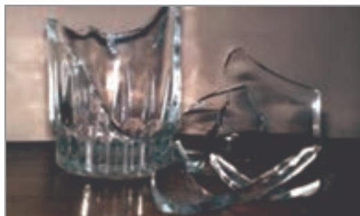
شکل ۸- شکستن شیشه سرد با ریختن مایع داغ
