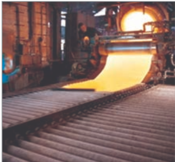
شکل ۲۰- فرایند ساخت شیشه تخت
