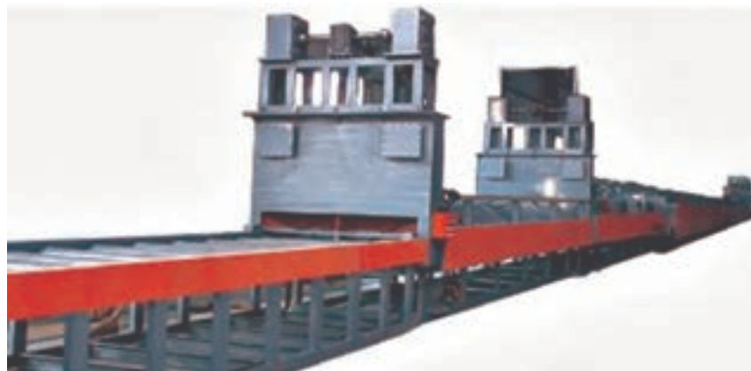
شکل ۱۲- کوره رولری برای عملیات تمپر حرارتی
