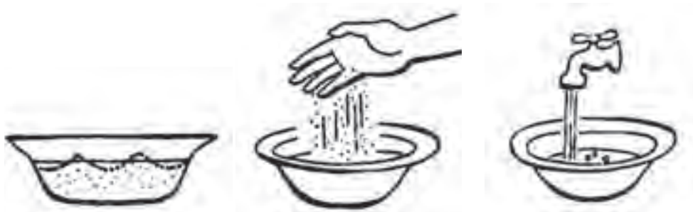
۱- ریختن مقدار مشخصی آب در ظرف ۲- پاشیدن گچ داخل آب ۳- تشکیل جزایری از گچ در سطح آب
