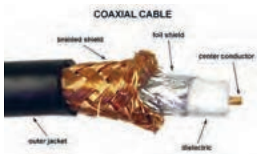
شکل ۸- اجزای کابل کوآکسیال
