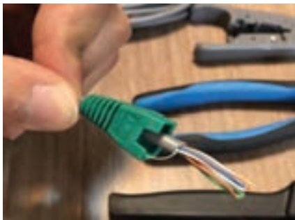
شکل ۲۶- وارد کردن کاور سوکت سر کابل
