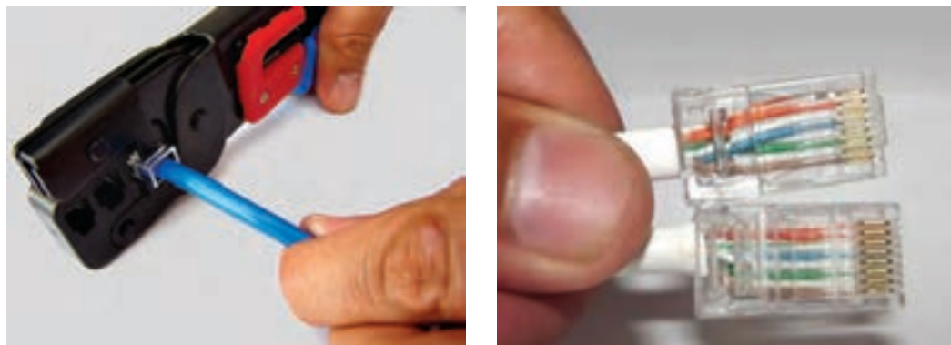
شکل ۲۹- پرس کردن سوکت RJ45
