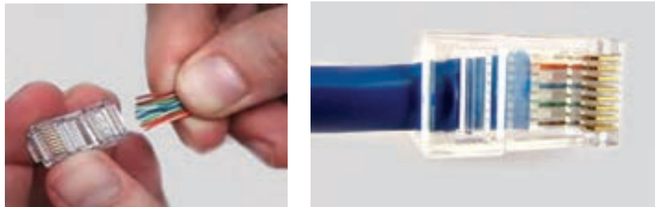
شکل ۲۸- قرار دادن سیم‌ها در سوکت
