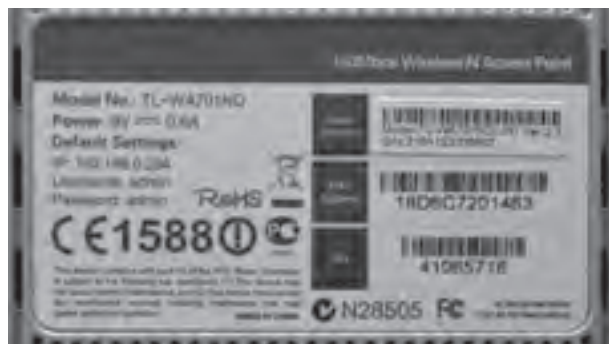
شکل ۳۱- آدرس IP، نام کاربری و گذرواژه در برچسب پشت و دفترچه راهنمای دستگاه AP
