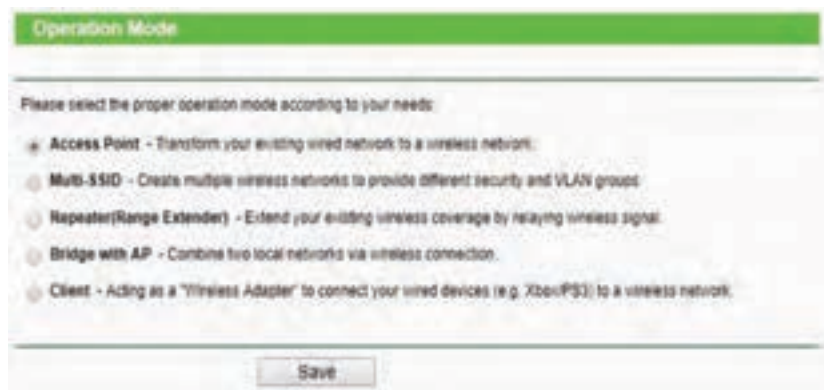
شکل ۴۱- انواع mode در AP
