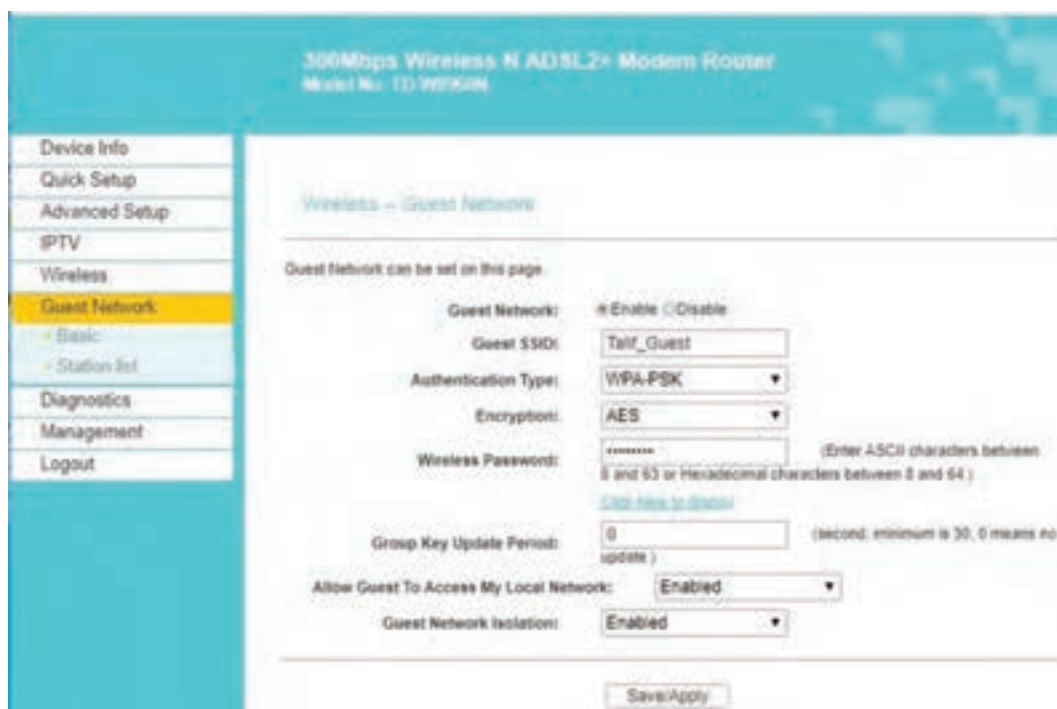
شکل ۶۸ - تنظیم Guest Network روی مودم
