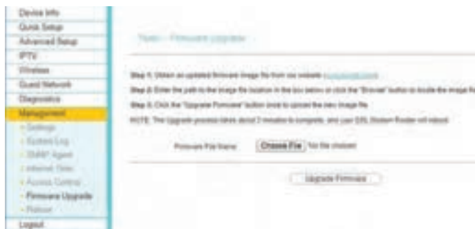
شکل ۶۱- به روزرسانی Firmware مودم
