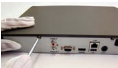
شکل ۳۲- بازکردن درپوش NVR
