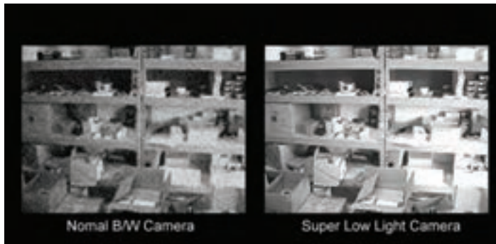
شکل ۱۸- تأثیر مشخصه Minimum Illumination در تصویر
