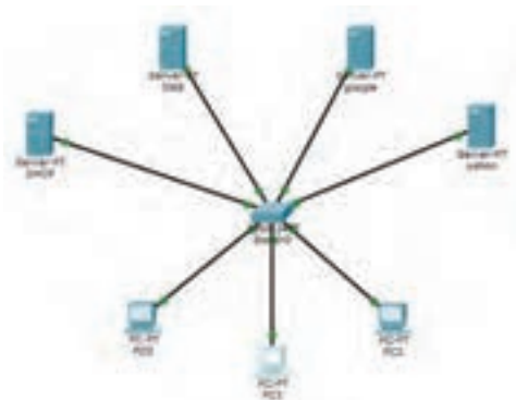
شکل ۳۹- شبیه‌سازی سرویس HTTP
