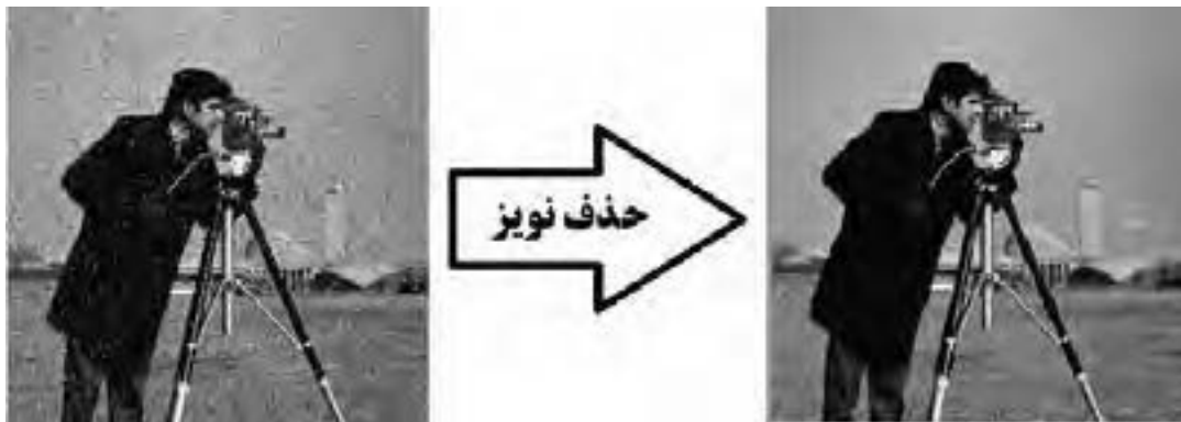
شکل ۱۴- کاربرد پردازش تصویر سطح پایین در حذف نویز تصویر
