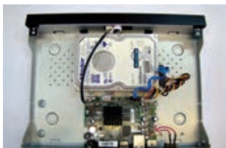
شکل ۳۵- محکم کردن دیسک سخت در محل نصب
