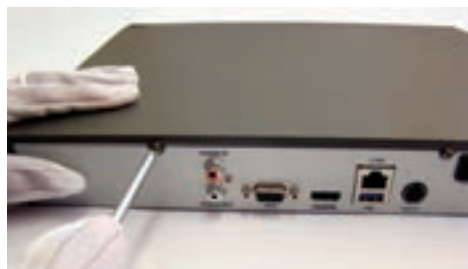
شکل ۳۲- باز کردن درپوش NVR
