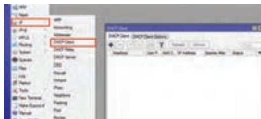
شکل ۳۰- پنجره تنظیمات DHCP Client
