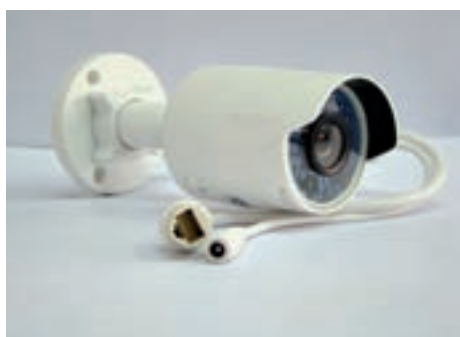
شکل ۱- اجزای دوربین تحت شبکه
