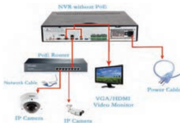
شکل ۱۷- اتصال دوربین به NVR
