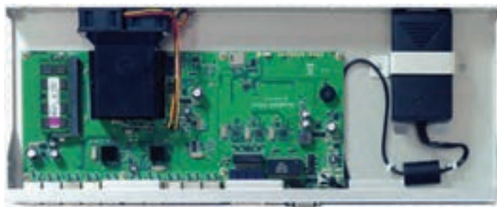
شکل ۴- نمای داخلی مسیریاب میکروتیک
