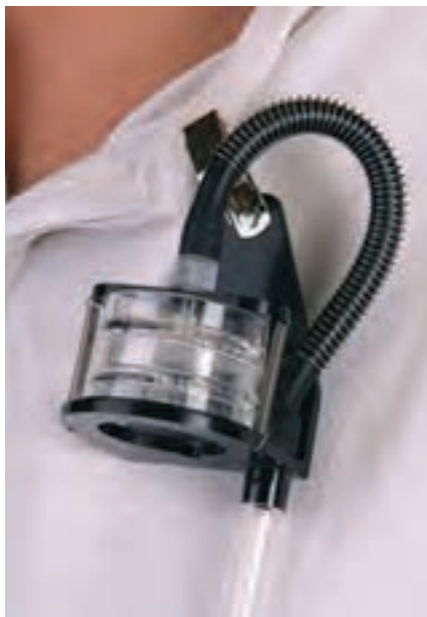
نصب صافی در ناحیه تنفسی شخص نمونه‌گیر
