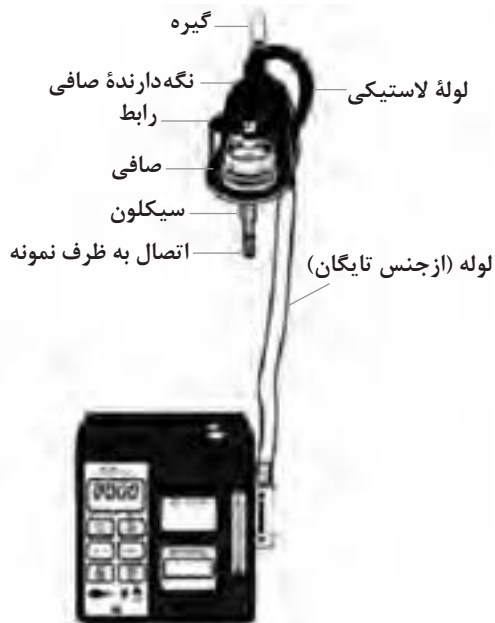
شکل ۲۲- شیوه اتصال صافی به پمپ نمونه گیر هوا
