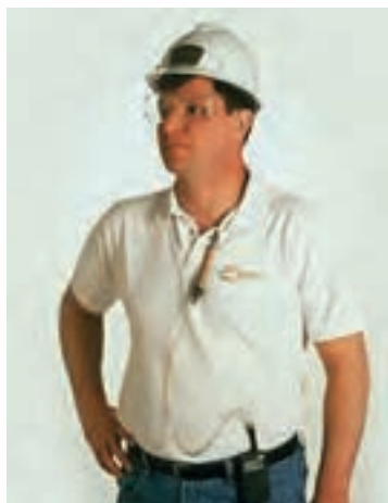
شکل ۱۸- شیوه اتصال دستگاه لوله جاذب به شخص نمونه‌گیر
