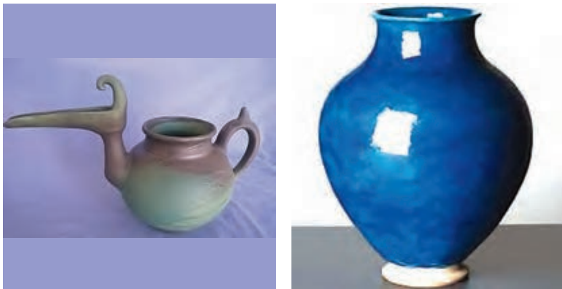
شکل ۳۸- انواع لعاب با ویژگی ظاهری شفاف و کدر
