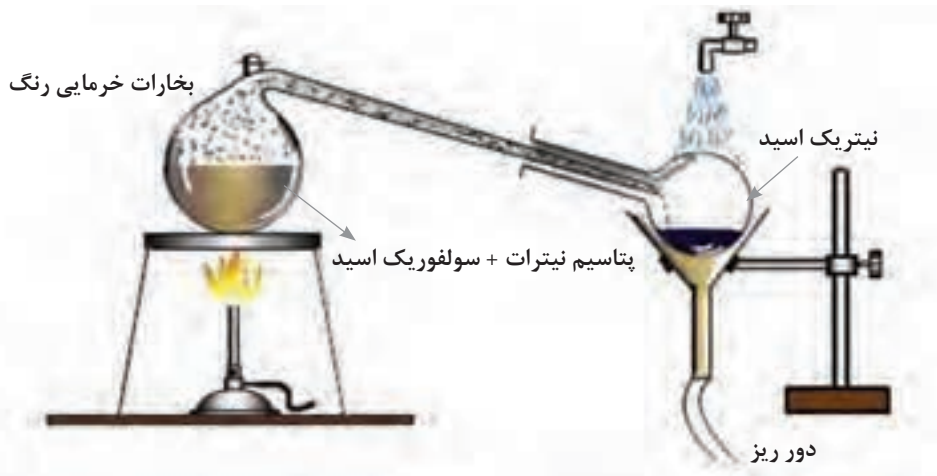
شکل ۷- سامانه تهیه نیتریک اسید
