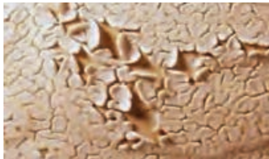
شکل ۴۲- پوسته شدن و ترک خوردگی در لعاب
