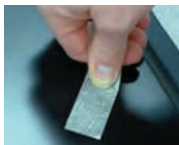
شکل ۲۳- مراحل انجام آزمایش چسبندگی به روش صلیبی
