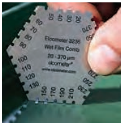
شکل ۱۹- شانه ۱ مخصوص اندازه‌گیری ضخامت فیلم تر رنگ
