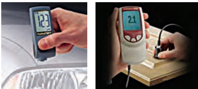
شکل ۲۲- انواع ضخامت‌سنج فیلم خشک رنگ (غیر تخریبی)
