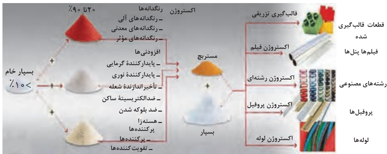
شکل ۶- فرایند تولید مستر بیج و قطعات بسیاری
