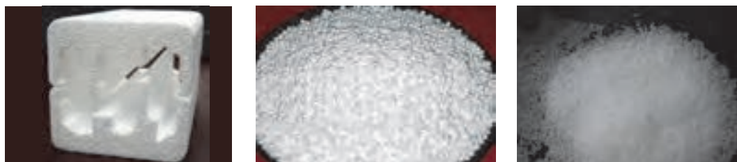
شکل ۱۳- از چپ به راست: گرانول پلی‌استیرن انبساطی، گرانول منبسط شده و محصول نهایی که با نام یونولیت می‌شناسید.
