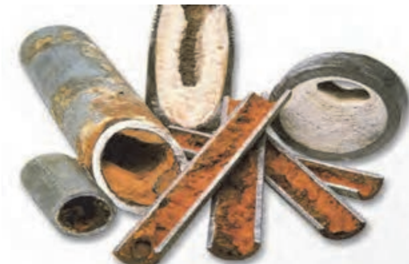
شکل ۴- خوردگی و رسوبات تشکیل شده در لوله‌های دیگ بخار
