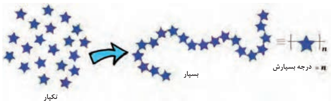
شکل ۱۰- الگوی تشکیل بسپار از تکپارها
