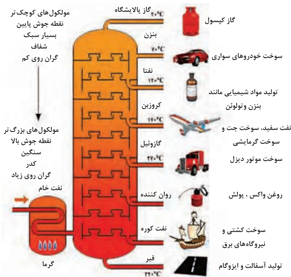
شکل ۲ - جداسازی صورت گرفته بر روی نفت خام در یک واحد پالایشگاهی
