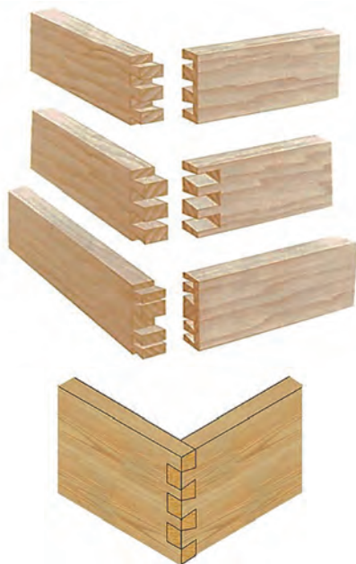
شکل ۲۶- نمونه‌هایی از اتصال گوشه‌ای دم چلچله با زبانه‌های
