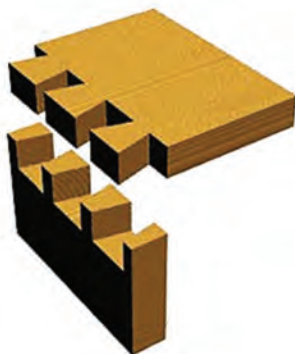
شکل ۲۷- تصویر سه بعدی از اتصال گوشه‌ای دم چلچله با سه
