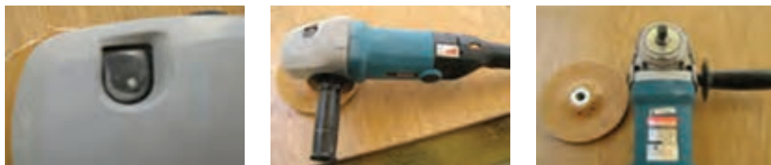
شکل ۱۷۴- اجزای سنباده دیسکی
