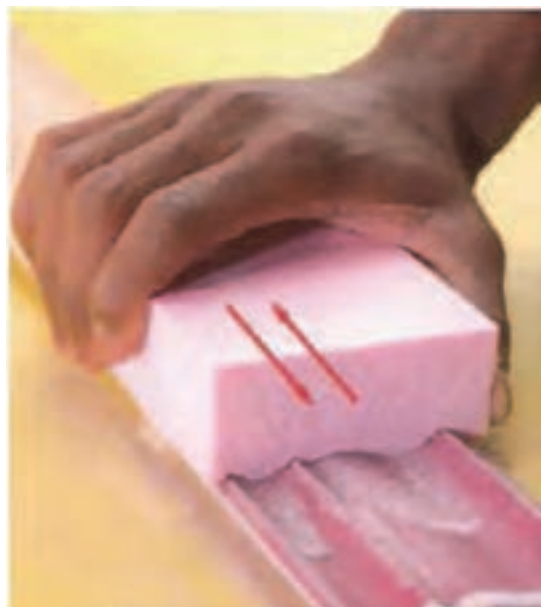
شکل ۱۰۸- تخته سنباده برای قطعه افزار خورده
