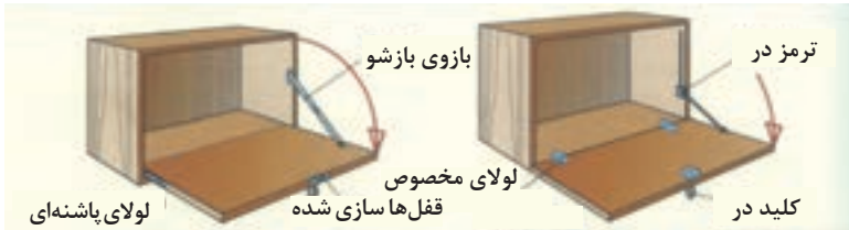
شکل ۱- در افقی، سمت چپ جاسازی در داخل، سمت راست جاسازی در روی قفسه
