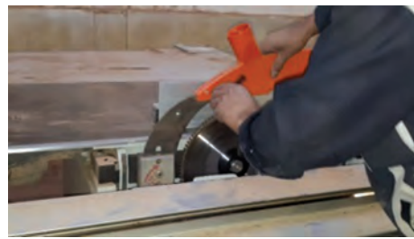
شکل ۶۷- بستن حفاظ و کاور روی تیغه اره
