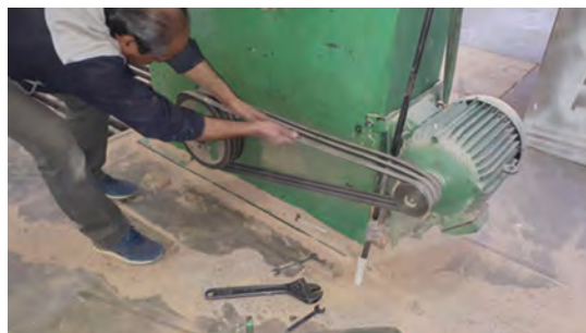
شکل ۵۹- روش باز کردن حفاظ و بررسی تسمه
