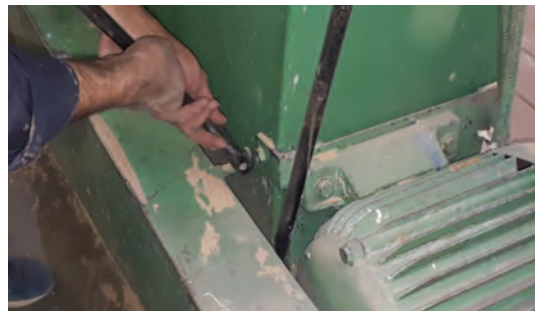
شکل ۵۹- روش باز کردن حفاظ و بررسی تسمه
