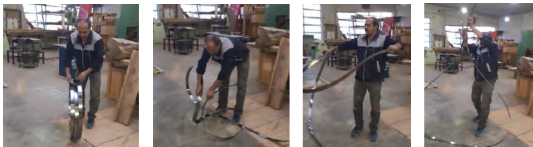
شکل ۱۹- روش جمع کردن تیغه اره نواری
