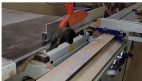
شکل ۶۷- بستن حفاظ و کاور روی تیغه اره
