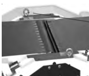
شکل ۲۶- موقعیت توپی رنده بین صفحات ورودی و خروجی ماشین رنده کف رند
