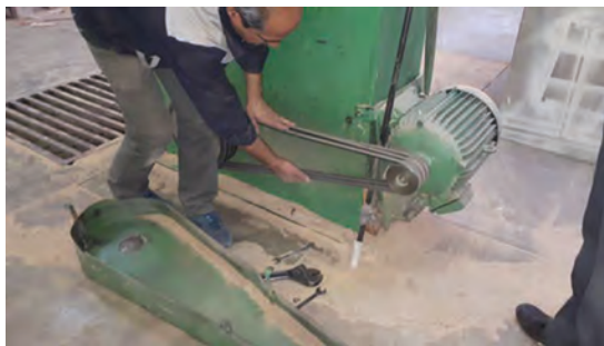
شکل ۵۹- روش باز کردن حفاظ و بررسی تسمه
