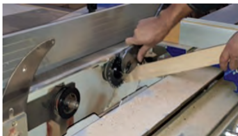
شکل ۶۴- باز کردن و بررسی تیغه خط زن
