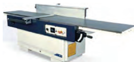
شکل ۲۳- الف) نمونه‌ای از ماشین کف رند با پوشش حفاظتی روی توپی تیغه
