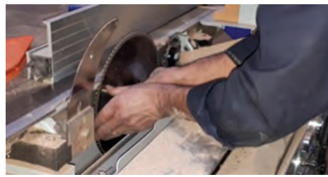
شکل ۶۵- بستن تیغه نو و نصب فلنج جلوی تیغه اره
