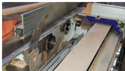
شکل ۶۳- بررسی فلنج پشت تیغه اره
