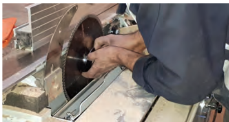
شکل ۶۵- بستن تیغه نو و نصب فلنج جلوی تیغه اره
