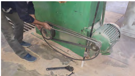
شکل ۵۹- روش باز کردن حفاظ و بررسی تسمه
