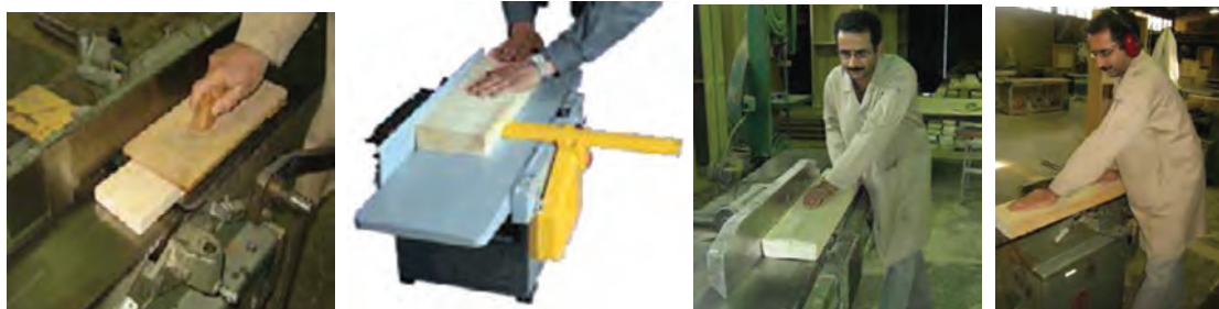
شکل ۲۹- نحوه رندیدن صحیح قطعه کار چوبی
