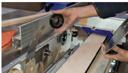
شکل ۶۳- بررسی فلنج پشت تیغه اره
