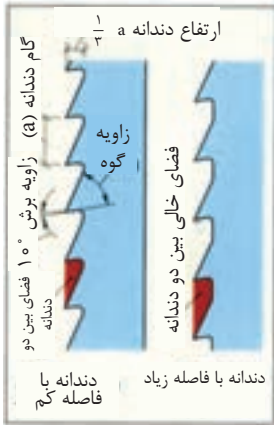
شکل ۱- تیغ اره نواری مناسب برش‌های طولی
