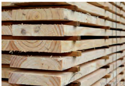
شکل ۱۳- روش چوب‌دستک‌گذاری در دسته‌های چوب
