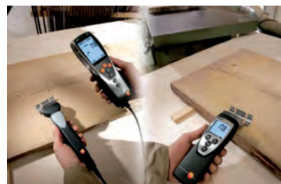
شکل ۶- دستگاه رطوبت سنج نوع دی الکتریک
