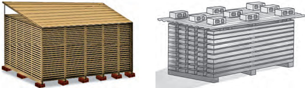
شکل ۱۷- پوشش واحد دسته بندی به وسیله پوشش یا آفتاب گیر
