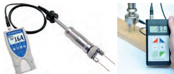
شکل ۷- دستگاه رطوبت سنج نوع مقاومت الکتریکی
