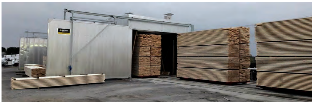
شکل ۶۵- بارگیری دسته‌بندی‌های چوب به طریق طولی
