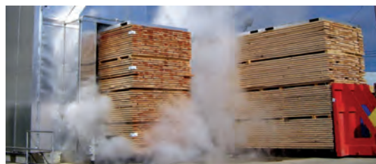
شکل ۶۴- اصول دسته‌بندی چوب روی واگن
