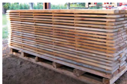
شکل ۱۳- روش چوب‌دستک‌گذاری در دسته‌های چوب
