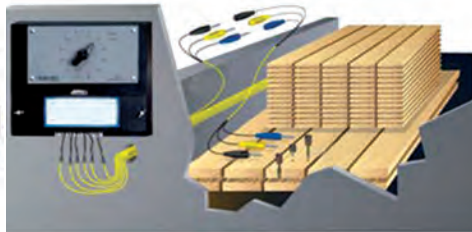
شکل ۵۸- نحوه قرارگرفتن الکتروود رطوبت‌سنج چوب در واحد دسته‌بندی
