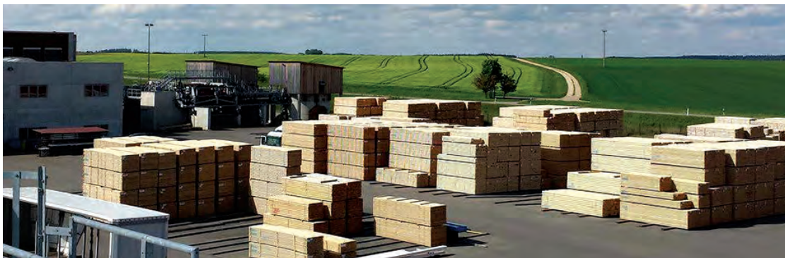
شکل ۱۱- نحوهٔ قرارگیری دسته‌بندی‌ها و خیابان‌های یارد
