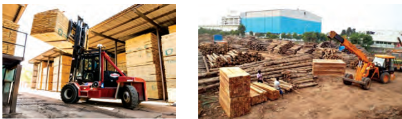
شکل ۱۶- جابه‌جا کردن واحد دسته‌بندی به وسیله لیفت‌تراک (سمت چپ) و جرثقیل (سمت راست)
