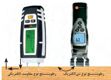
شکل ۸- روش کار رطوبت سنج های الکتریکی
