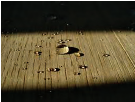
شکل ۷۲- نمونه چوب ضدآب شده با کمک نانوذرات
