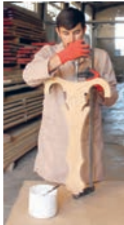
شکل ۱۰۴- کنترل صحیح بودن اتصالات و مونتاژ تاج و پشتی
