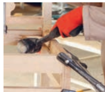
شکل ۱۰۷- جا زدن نبشی به وسیله چکش پلاستیکی
