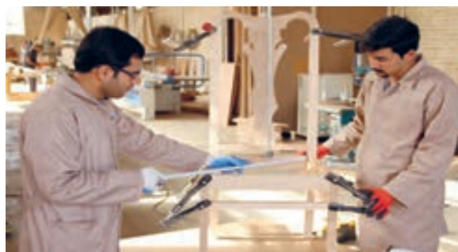
شکل ۱۰۹- کنترل دوئیدگی با متر
