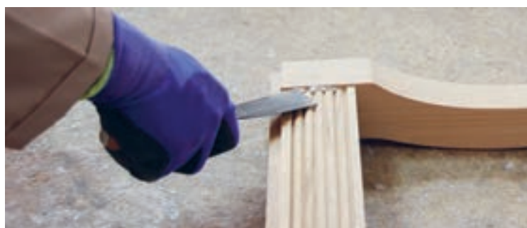
شکل ۱۰۲- تمیز کردن چسب اضافی با کاردک
