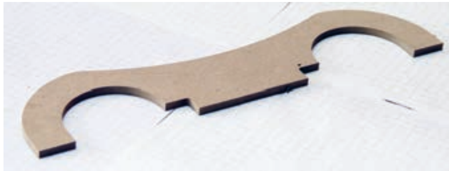
شکل ۶۵- شابلون تاج و پشتی صندلی
