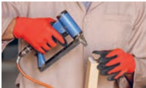
شکل ۱۱۱- مراحل نصب فیبر ۳ میلی متر با منگنه کوب
