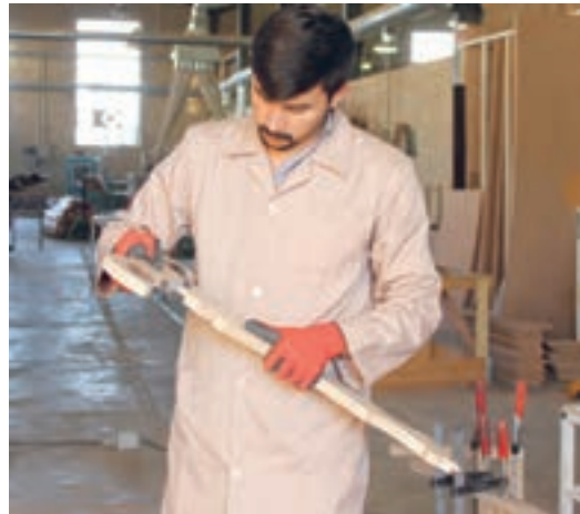
شکل ۱۰۴- کنترل صحیح بودن اتصالات و مونتاژ تاج و پشتی
