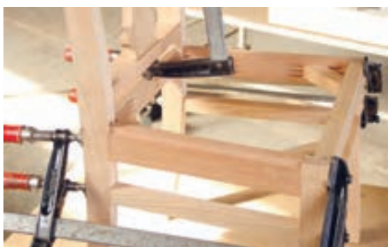
شکل ۱۱۰- نصب نبشی‌ها
