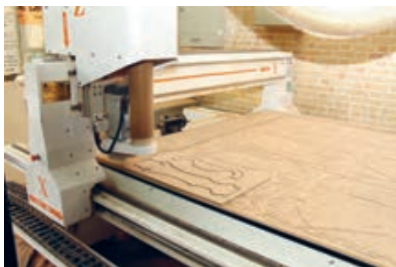
شکل ۶۷- تهیه شابلون با دستگاه فرز CNC
