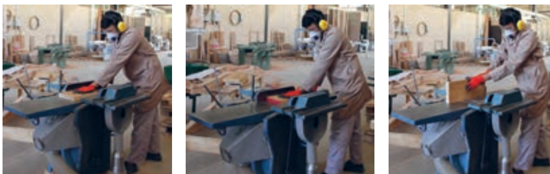
شکل ۷۰- یک رو و یک نرکردن چوب
