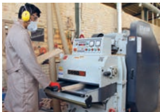
شکل ۷۸- نحوه گندگی کردن چوب‌های کم عرض
