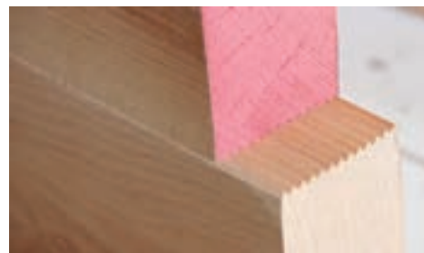
شکل ۱۳- اتصال انگشتی ساخته شده با دستگاه فرز
