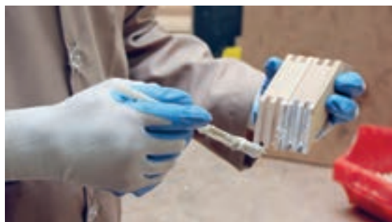
شکل ۱۰۸- چسب زدن نبشی‌ها
