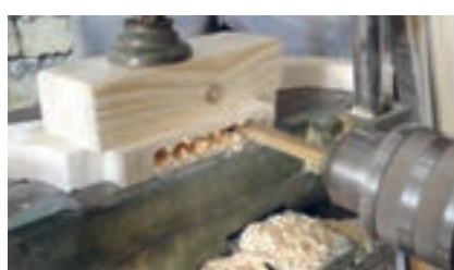
شکل ۸۸- عملیات کم‌کنی با دستگاه سه کاره
