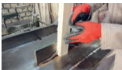
شکل ۹۱- عملیات برش زبانه با دستگاه اره گرد
