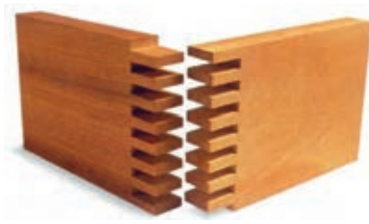
شکل ۱۱- اتصال انگشتی با تعداد زبانه زوج
