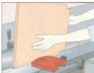
پرداخت کردن کفی با دستگاه کفرند
