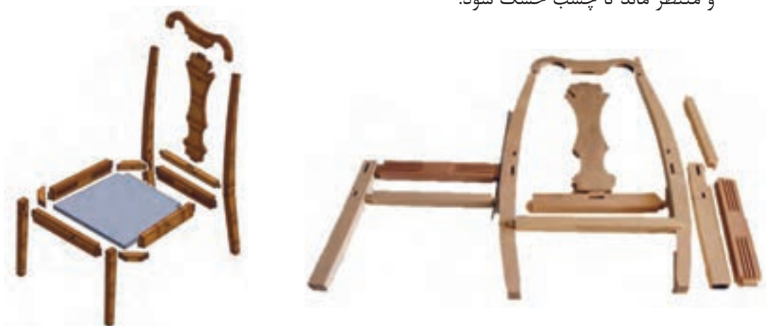
شکل ۹۶- قطعات آماده مونتاژ صندلی
