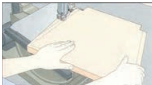
بریدن کفی توسط دستگاه اره نواری
