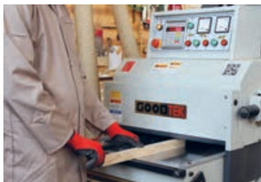
شکل ۷۸- نحوه گندگی کردن چوب‌های کم عرض
