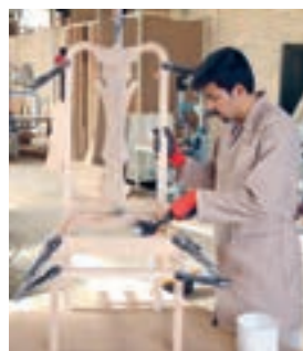
شکل ۱۰۷- جا زدن نبشی به وسیله چکش پلاستیکی
