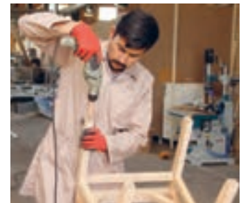
شکل ۱۱۲- سوراخکاری کف پایه با دریل
