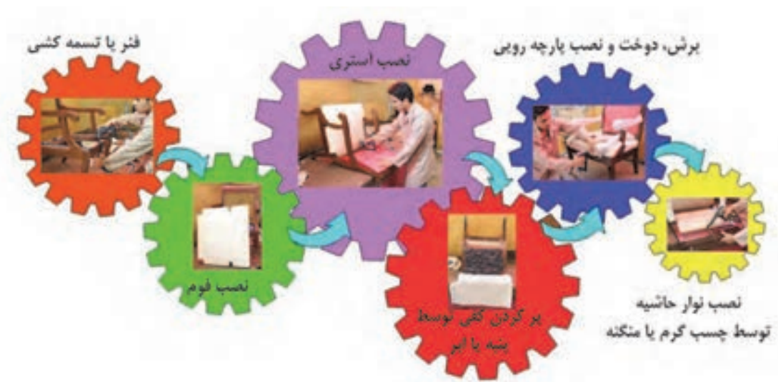
شکل ۲- مراحل اجرای رویه کوبی
