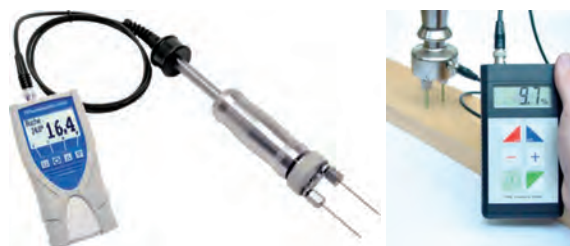
شکل ۷- دستگاه رطوبت سنج نوع مقاومت الکتریکی
