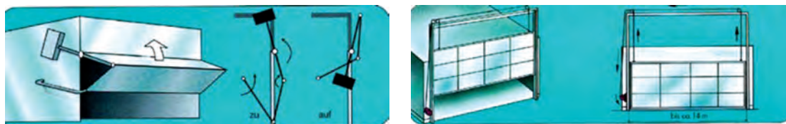
شکل ۳۳- در با حرکت عمودی برای کوره‌های بزرگ تا پهنای ۱۴ متر
