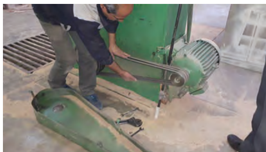
شکل ۵۹- روش باز کردن حفاظ و بررسی تسمه
