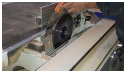
شکل ۶۱- باز کردن حفاظ و کاور روی تیغه اهر
