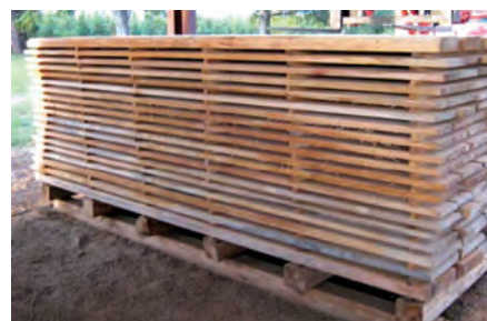
شکل ۱۳- روش چوب‌دستک گذاری در دسته‌های چوب
