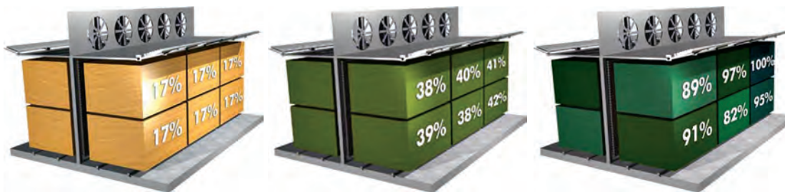
شکل ۶۸- مراحل مختلف خشک کردن چوب در کوره
