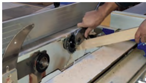
شکل ۶۴- باز کردن و بررسی تیغه خط زن
