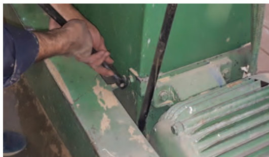
شکل ۵۹- روش باز کردن حفاظ و بررسی تسمه
