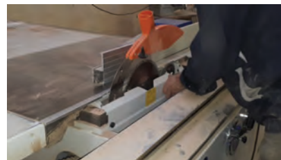
شکل ۶۱- باز کردن حفاظ و کاور روی تیغه اهر
