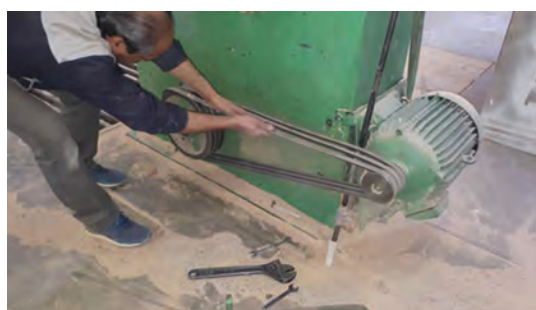
شکل ۵۹- روش باز کردن حفاظ و بررسی تسمه
