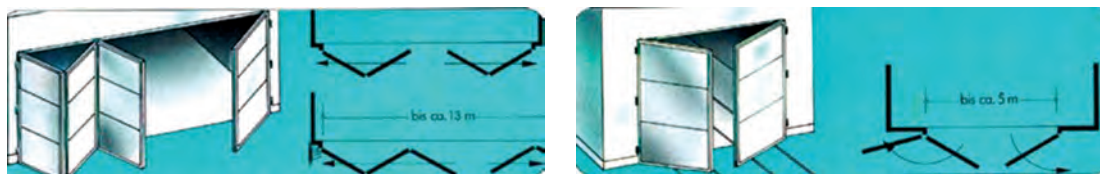
شکل ۳۰- در بادبزی تکی یا دوتایی برای کوره‌های کوچک شکل ۳۱- در تاشو برای کوره‌های بزرگ‌تر تا پهنای ۱۳ متر با پهنای تا ۵ متر
