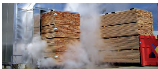
شکل ۶۴- اصول دسته بندی چوب روی واگن
