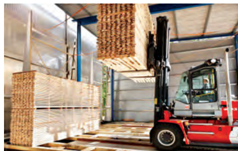
شکل ۲۳- سیستم بارگیری کوره به وسیله لیفت‌تراک
