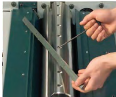
شکل ۲۷- روش تعویض تیغه رنده و نحوه قرار گرفتن تیغه و استقرار آن روی توپی
