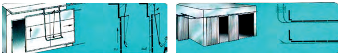
شکل ۳۲- در ریلی برای کوره‌های با پهنای تا ۱۳ متر
