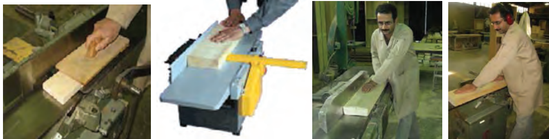
شکل ۲۹- نحوه رندیدن صحیح قطعه کار چوبی
