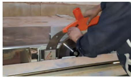
شکل ۶۷- بستن حفاظ و کاور روی تیغه اره
