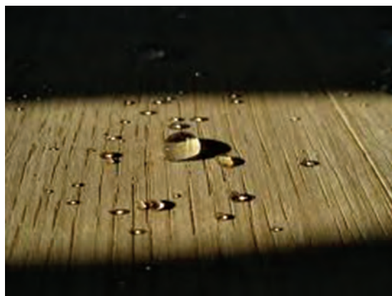
شکل ۷۲- نمونه چوب ضدآب شده با کمک نانوذرات
