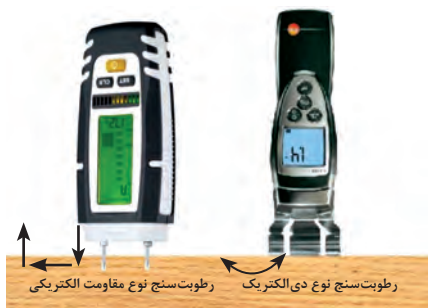
شکل ۸- روش کار رطوبت سنج های الکتریکی
