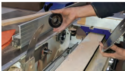
شکل ۶۳- بررسی فلنج پشت تیغه اره
