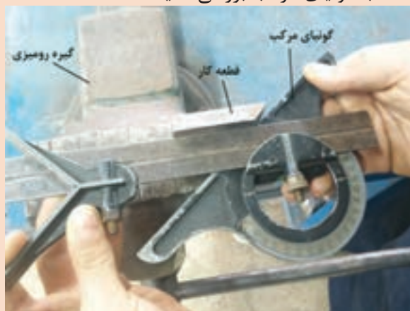
شکل ۲۳- بررسی صحت زاویه با گونیای مرکب
