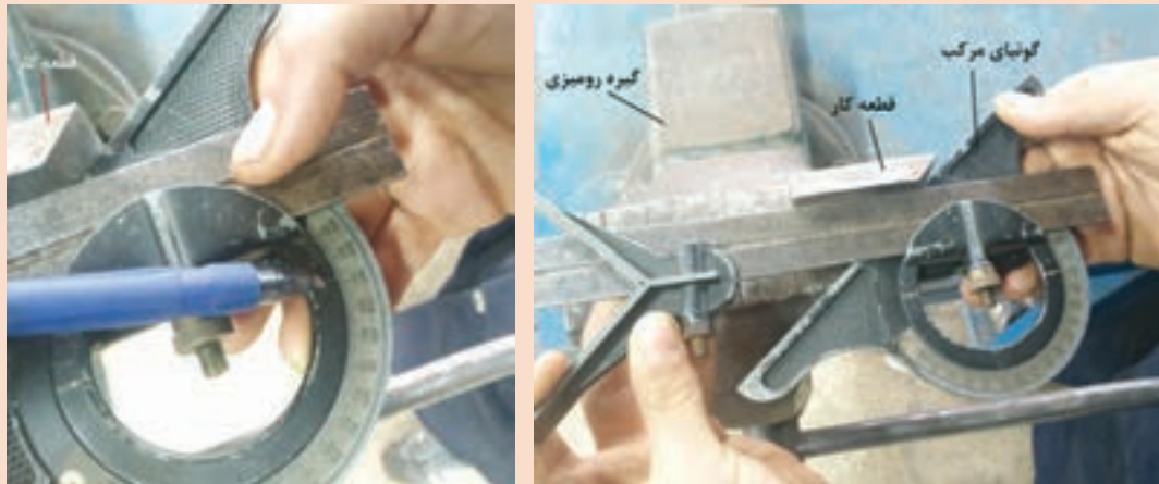
شکل ۲۰- بررسی صحت زاویه با گونیای مرکب
