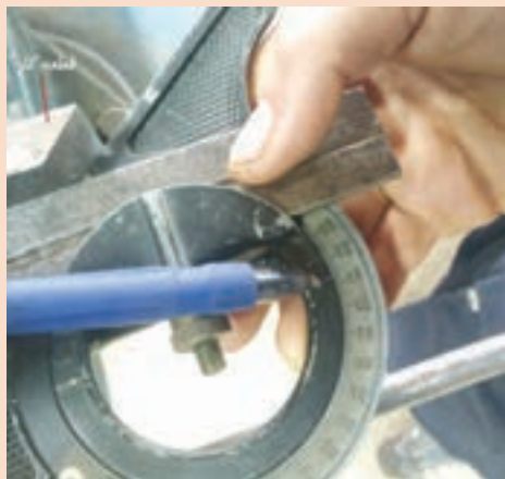
شکل ۲۳- بررسی صحت زاویه با گونیای مرکب
