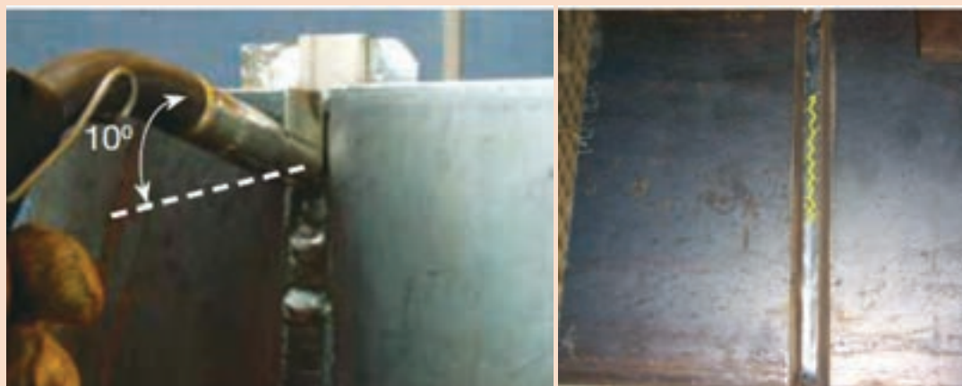
شکل ۲۴- زاویه تورچ و جهت حرکت آن
