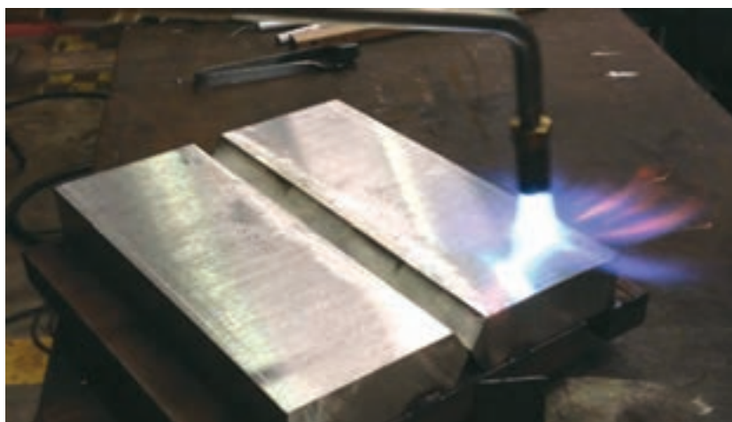
شکل ۵- پیش گرم کردن قطعه ضخیم توسط شعله
