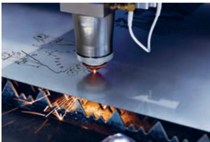
شکل ۱۹: برشکاری با پرتو لیزر
