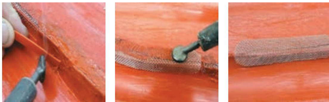
شکل ۲۹- استفاده از توری فلزی در تعمیر قطعات پلاستیکی
