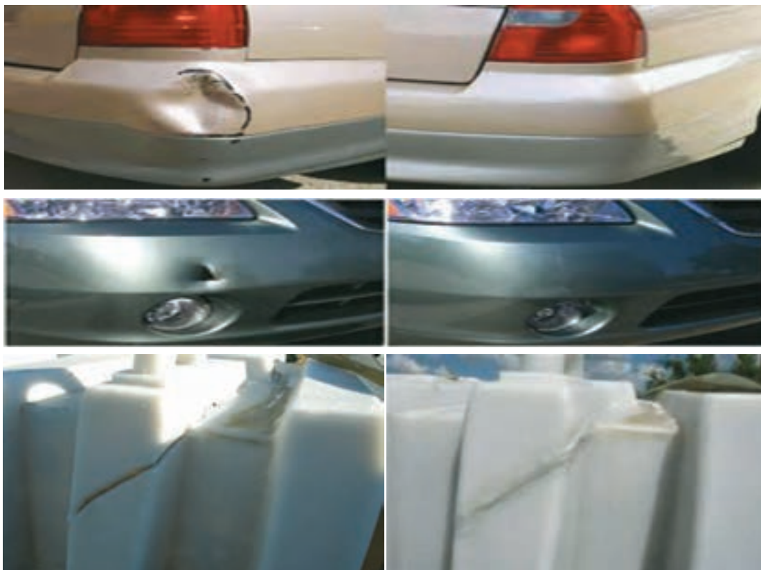
شکل ۲۳- نمونه‌هایی از جوش تعمیری قبل و بعد از جوشکاری
