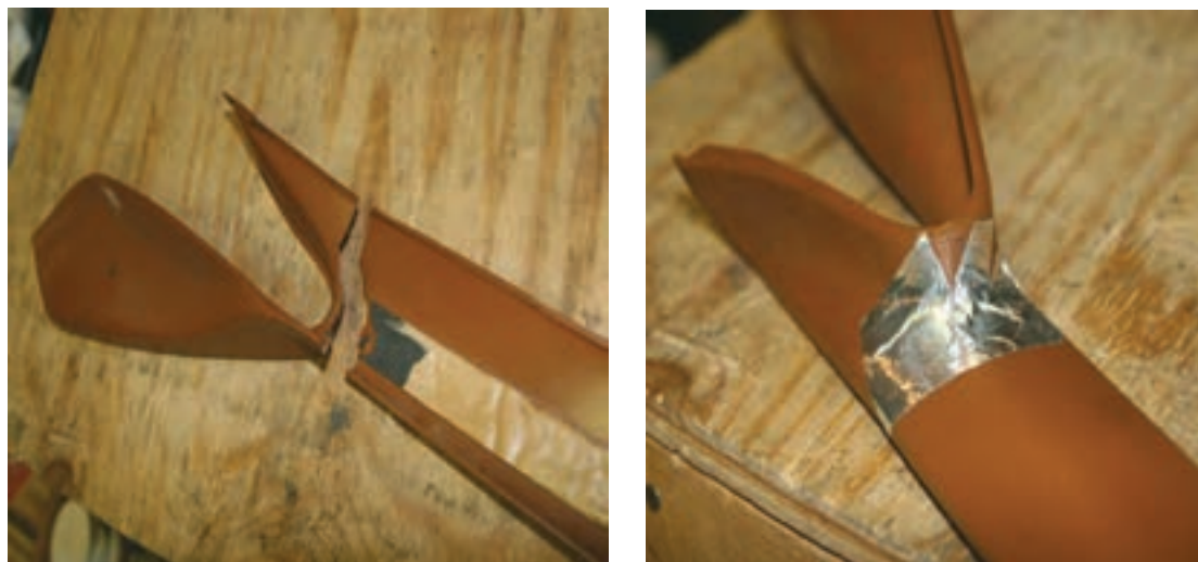
شکل ۲۸- همتراز کردن قطعه به کمک فویل آلومینیومی
