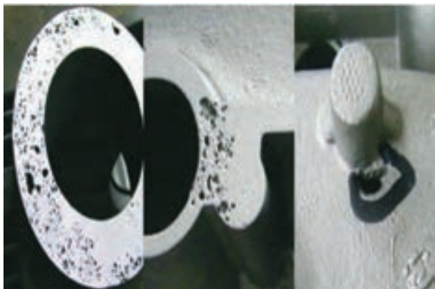
تلاطم مذاب حین ریختن آن در قالب
