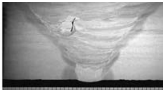
شکل ۳۲- ترک‌های داخلی درون جوش
