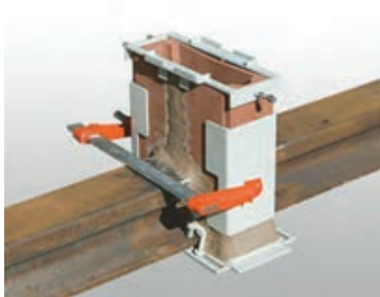
شکل ۷- قالب جوشکاری ترمیت و قرارگیری آن در اطراف ناحیه اتصال
