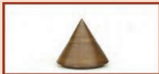
شکل ۱۰- قطعه مخروطی برای باز دهانه لوله
