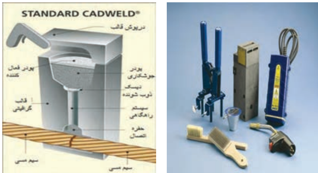
شکل ۳۰- تجهیزات جوشکاری احتراقی
