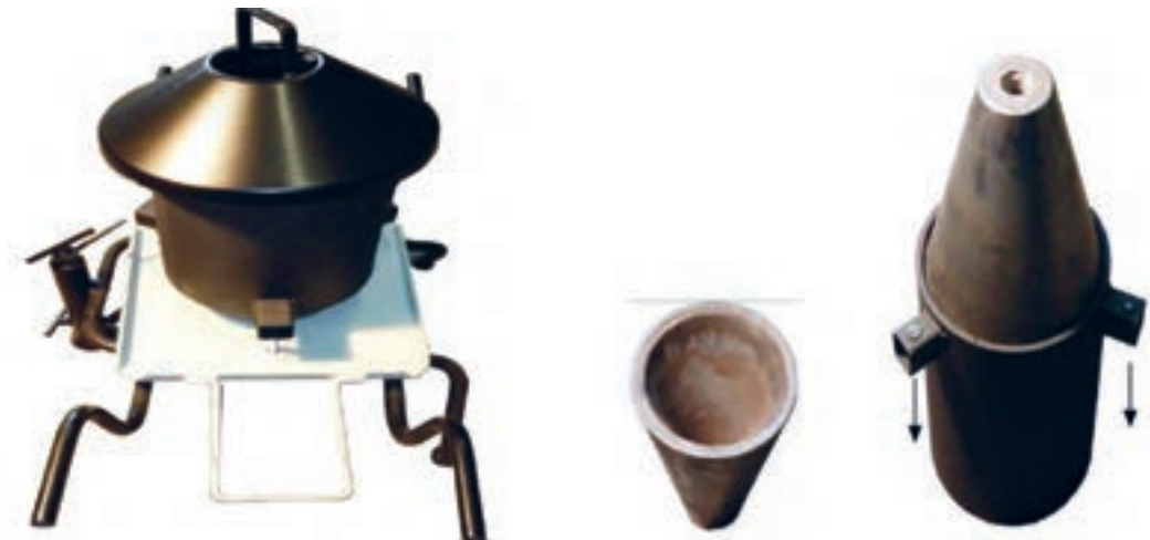
شکل ۶- بوته نگهدارنده مذاب
