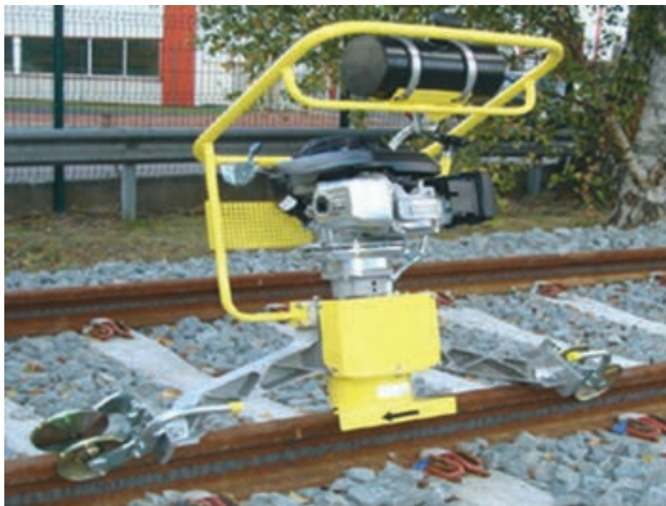
شکل ۱۳- ماشین اتوماتیک سنگ زنی گرده اضافی جوش
