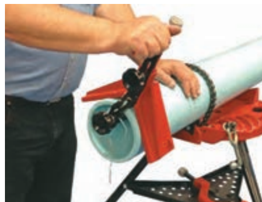
شکل ۲۴- پخ زدن قطعات پلاستیکی برای جوشکاری
