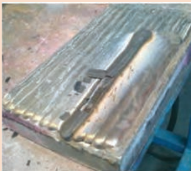
شکل ۲۱ - شکل نهایی قطعه کار پوشش شده با جوش پوششی
