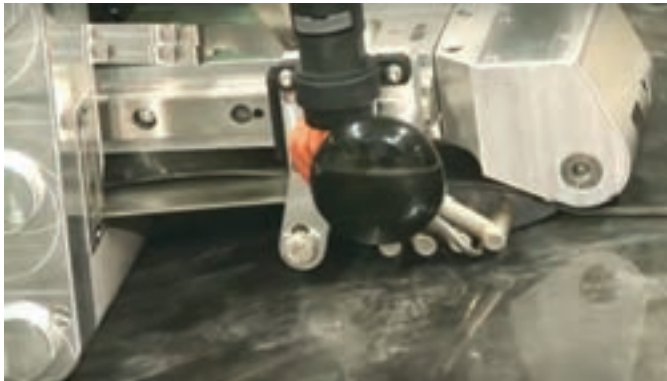
شکل ۶- جوشکاری با گوه داغ (Hot Wedge) و دستگاه جوش آن
