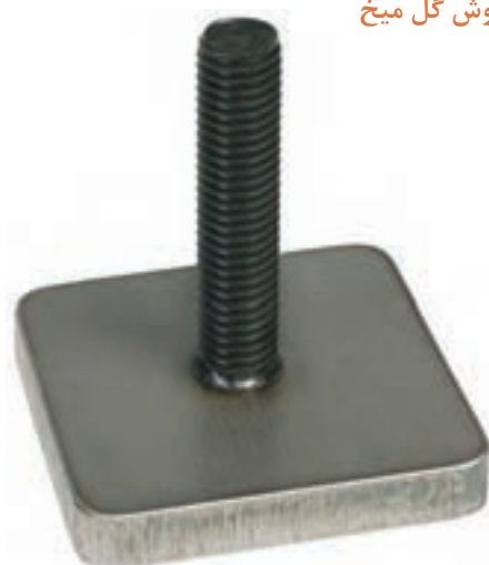
شکل ۲- اتصال ایجاد شده به روش گل میخ
