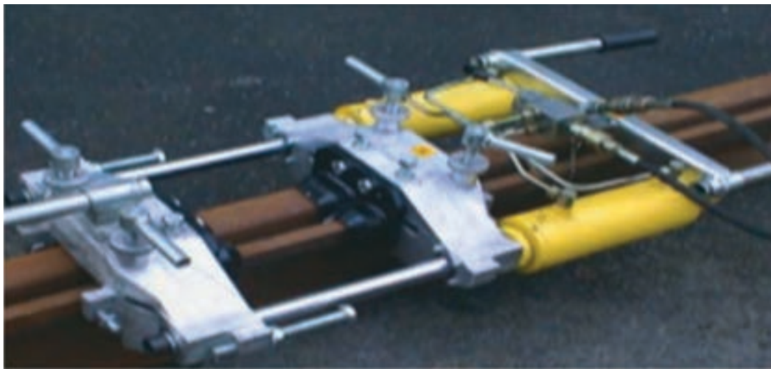
شکل ۱۲- ماشین هیدرولیک برش گرده اضافه جوش
