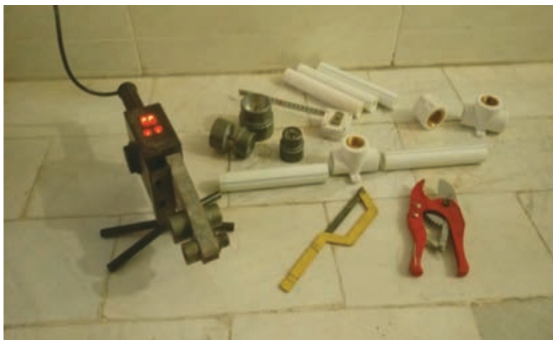
شکل ۲۰- تجهیزات جوشکاری لوله‌های پلاستیکی
