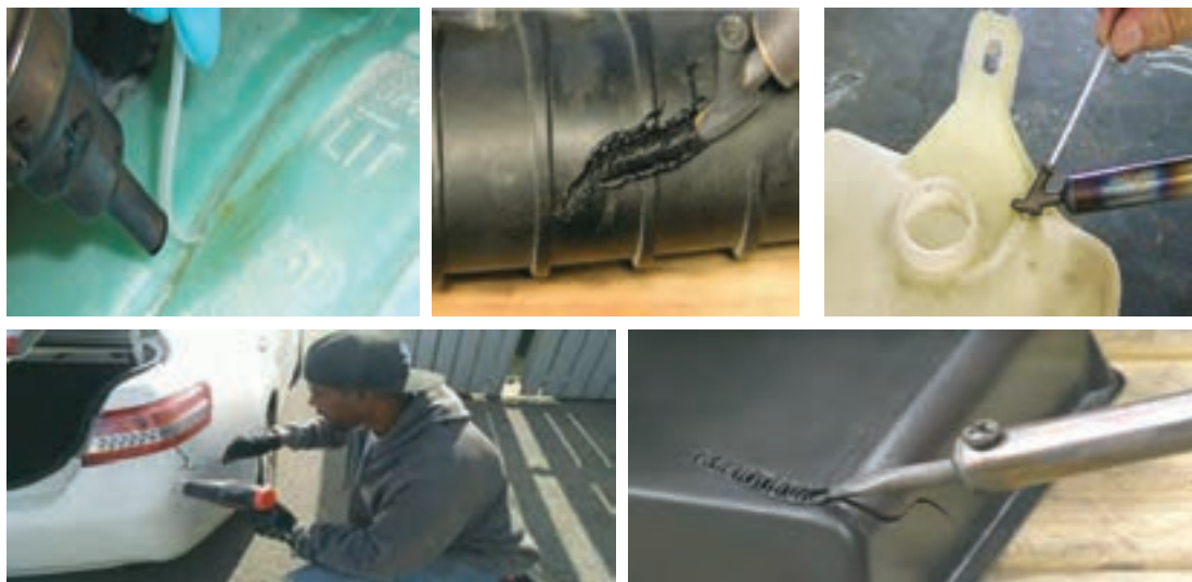
شکل ۲۲- جوشکاری تعمیری قطعات پلاستیکی
