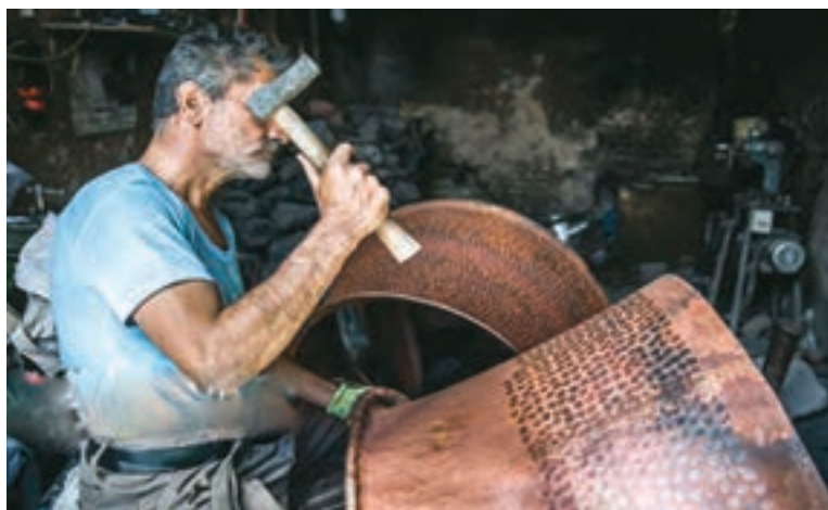
شکل ۳- استفاده از تکنیک فورج و طرح دم چلچله در اتصال دیگ های مسی
